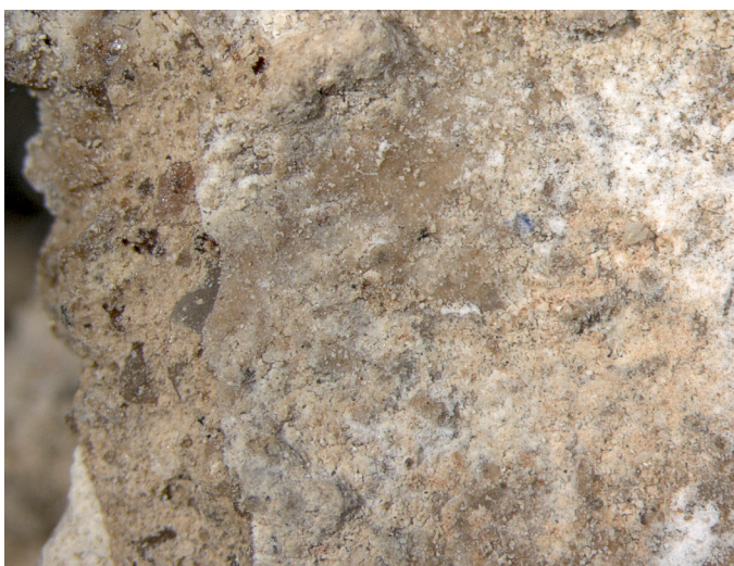
▲ Abb. 12 Mikroskopische Aufnahme des Probestückchens des römischen Fugenmörtels vor der Einbettung, Schrägbeleuchtung von oben, Auflicht, 12-fach (Aufnahme, Labor F. Mucha, Januar 2024).
