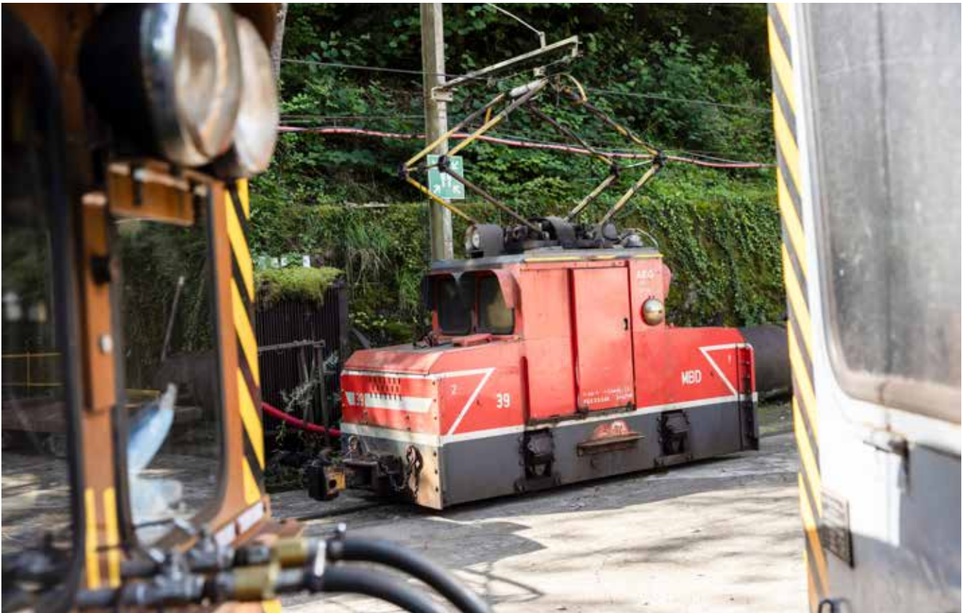
La locomotive électrique ARBED 39 de 1927 a été utilisée dans les mines d'Esch-Hiehl. La partie mécanique de la machine a été assemblée dans les ateliers ARBED à Dommeldange, tandis que les composants électriques proviennent d'AEG Berlin.
