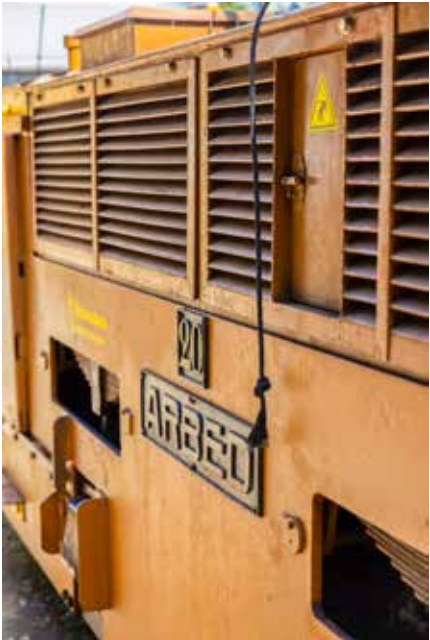
La locomotive électrique ARBED Mines 20 de type U28, construite par AEG en 1912, a été utilisée dans la mine des Terres Rouges.
