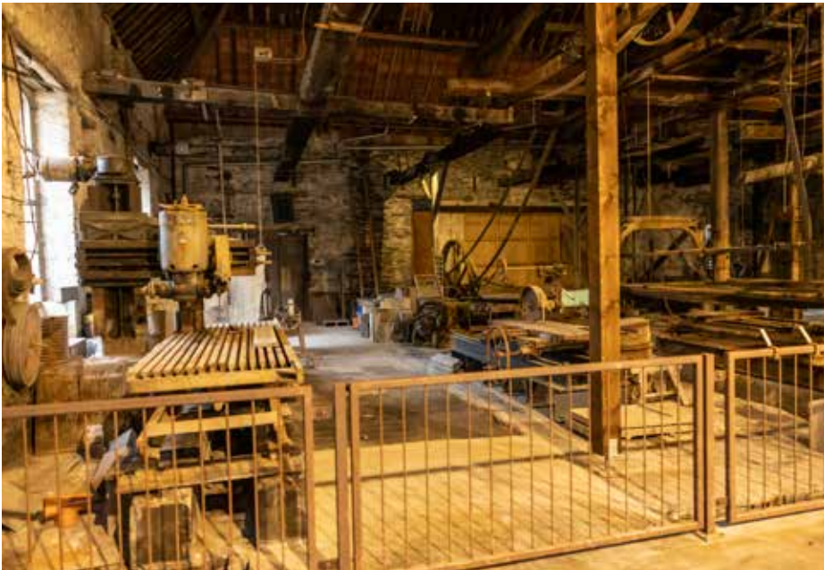
Les grandes scies à cadre servaient à découper les blocs de schiste pour en faire des plaques destinées à la fabrication de pierres tombales ou de lavabos. Dans l'ancienne forge et à la menuiserie, les outils nécessaires à l'industrie du schiste étaient fabriqués.
