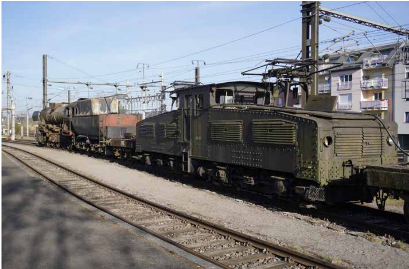
La locomotive électrique HADIR 11, pesant 100 tonnes, a été acquise en 1956 par l'usine HADIR de Differdange. Construite par Siemens-Henschel en Allemagne, cette locomotive de 1.305 chevaux était principalement utilisée pour le transport de marchandises au sein de l'usine.
