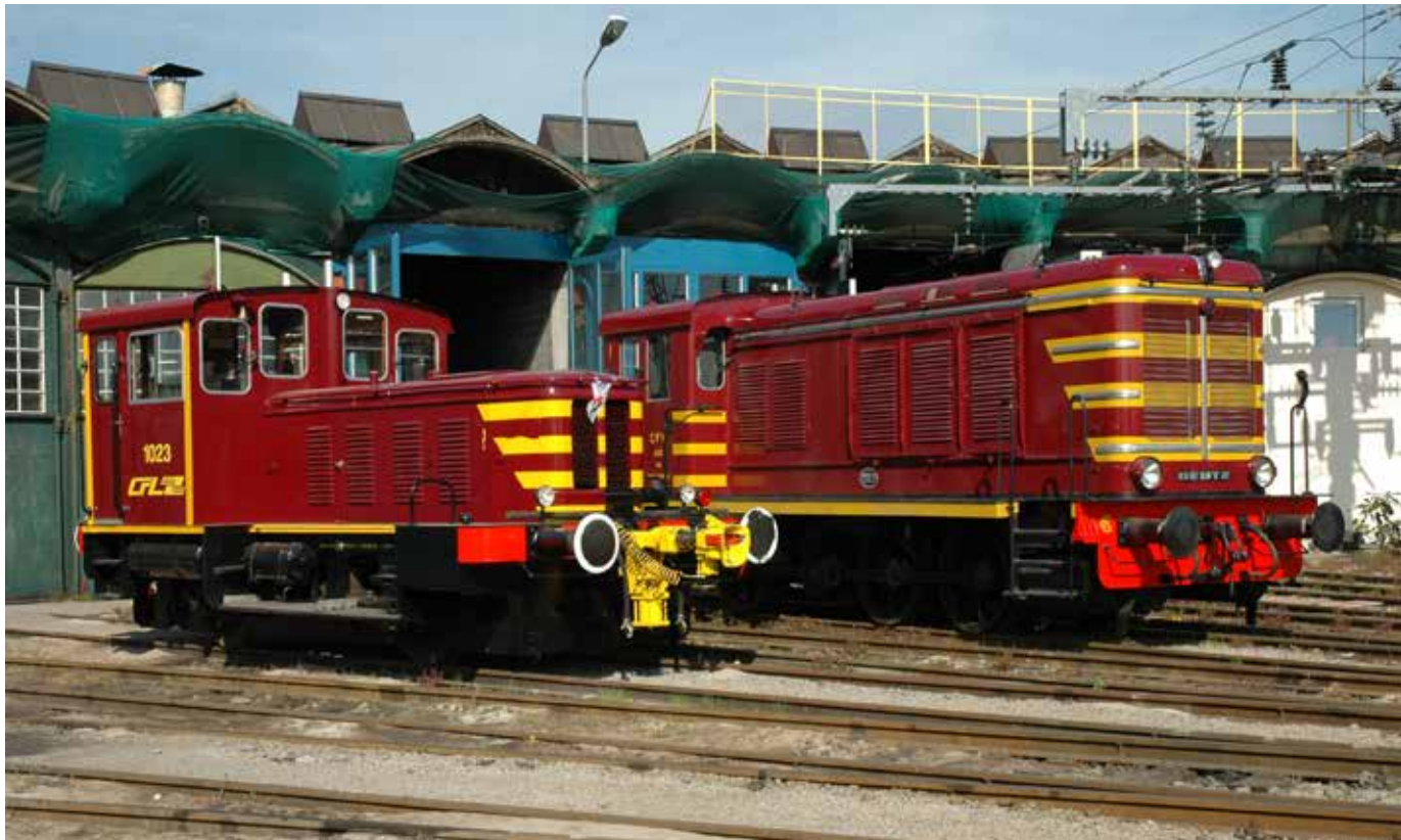
La locomotive diesel 455 (à droite) date de 1953. Ce type d'engin fut conçu pendant la Deuxième Guerre mondiale pour la traction des trains militaires. Sa technique diesel-hydraulique se révélait très fiable, de sorte que plusieurs sociétés ferroviaires ont acquis ces locomotives entre 1945 et 1957. Les CFL ont en acquis cinq destinées à des tâches de manœuvre et des trains marchandises entre 1953 et 1988. La locomotive diesel 455 reste l'unique modèle de ce genre et fut restaurée en 2005 par l'association 1604 Classics.
